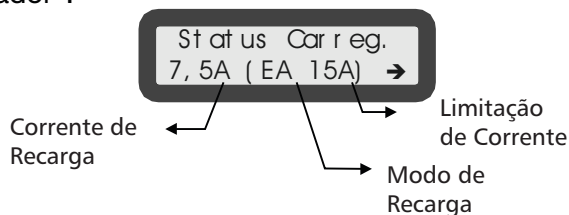
Figura 11 - Mensagem "Status do Carregador"
