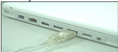
Coloque o conector USB na porta USB do seu desktop ou laptop de acordo com este diagrama. Após detectar o pen tablet, o Windows vai tentar instalar um driver para ele.
