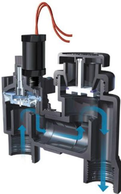
FIGURA 04 - Válvula solenóide, visão interna.
