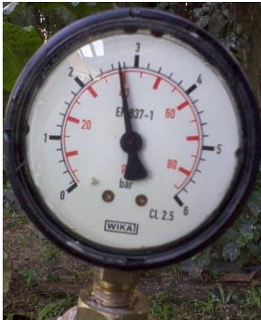
FIGURA 23 - Pressão máxima da motobomba com todos os aspersores fechados.
