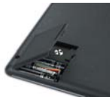
Compartimento das Baterias
