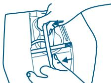
Recoloque a bica encaixando primeiro o lado esquerdo e depois o lado direito.
