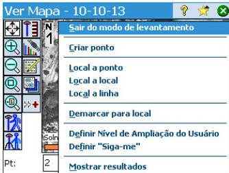
Se Óptico ou GNSS for selecionado, o mapa principal também pode funcionar como uma interface para coletar medições. Toque e mantenha o dedo no mapa principal e selecione o **Modo de Levantamento** para ativar a interface de Medição (veja a tela de exemplo para GNSS).
