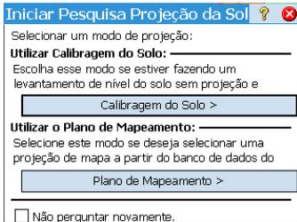
1. **Calibragem do Solo:** Escolha esta opção se não houver uma projeção conhecida ou datum para relacionar as coordenadas de sua grade local às coordenadas geodésicas (com esta opção, você confirma sua decisão de usar o controle local para montar um sistema de coordenadas). A seleção de um geóide fica possível depois de ter feito essa opção.
