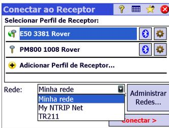
Mais tarde, quando iniciar um levantamento, é solicitada uma especificação da rede na qual o seu receptor vai trabalhar. Escolha o nome do diagrama de rede para especificar essa rede.
