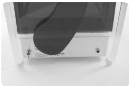
Fig 13. Painel localizado no lado inferior direito do SE900. O fornecimento de energia se conecta à entrada de fornecimento de energia à direita. O interruptor de ON / OFF alternância está do lado esquerdo.
