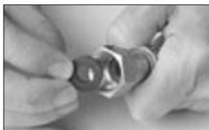
4. Coloque a arruela de vedação dentro da rosca interna da mangueira metálica.
