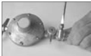
3. Coloque a outra braçadeira na extremidade oposta da mangueira. Em seguida, conecte a mangueira no regulador de pressão e, então, aperte a braçadeira com o auxílio de uma chave de fenda.
