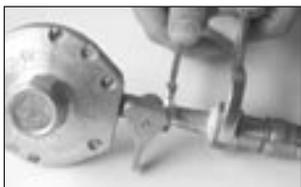
3. Rosqueie a mangueira metálica no regulador de pressão com o auxílio de duas chaves de boca. Utilize pasta vedante ou fita Teflon® para auxiliar na vedação.
