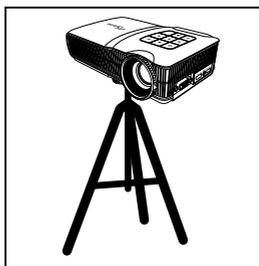
Parafuse o tripé padrão fornecido no orifício do parafuso do projetor.
