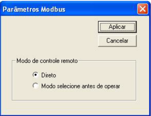
SFT2841: janela de parâmetros avançados Modbus.
