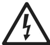
Perigo! Tensão perigosa. Contato causará choque elétrico.
