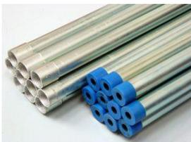
Utilizar eletrodutos metálicos galvanizados e sem costura separados de outras tubulações ou cabos de alimentação com alta potência. Necessários eletrodutos de 3/4" do tacômetro à unidade de controle 9270XN. Se utilizada mais de uma ponte de pesagem, um de cada ponte de pesagem até a caixa de junção mais próxima, um da caixa de junção final até o 9270XN e eletrodutos de 3/4" do 9270XN até os equipamentos que receberão os sinais por ele disponibilizados.
