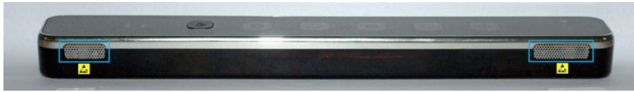
Figura 6 - Sensores ultrassônicos do receptor Station
