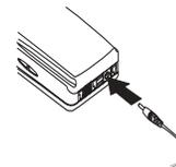
Quando o carregamento inicia, o telefone emite um bipe e o indicador de carga da bateria, no lado direito do visor, começa a se movimentar após alguns segundos.
