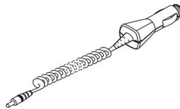
A faixa de voltagem é de 11 a 32V, corrente contínua, terra negativo. Evite carregamento prolongado com o Recarregador Rápido para Acendedor de Cigarros (LCH-9) se o motor do carro não estiver ligado, pois poderá descarregar a bateria do carro. Observe também que, em alguns veículos, o plugue do acendedor de cigarros não funciona se a ignição não estiver ligada.
