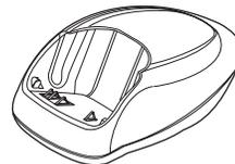
Com a bateria conectada, coloque o telefone no suporte para iniciar o processo de carga.
