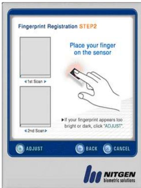
Coloque seu dedo no sensor de impressão digital, e use o slider para ajustar o brilho. Faça o ajuste de forma que a imagem de impressão digital não apareça muito escura ou muito clara.
