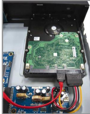
Passo 4: Alinhar o furo do parafuso no suporte de cada um com o orifício do parafuso do lado de cada o HDD como mostrado abaixo, e fixar o HDD ao suporte com um parafuso de HDD fornecido.
