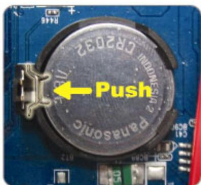
Passo 5: Faça uma nova bateria com o lado de " CR2032 "virado para cima, e instalá-lo à placa-mãe.
