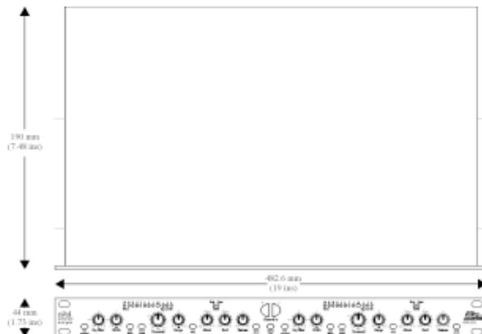
Figura 1.2 Dimensões do rack
