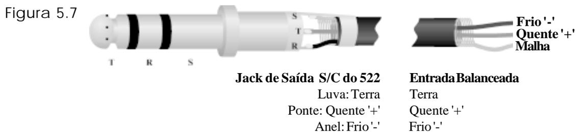
Conexões com entradas desbalanceadas devem ser feitas com a ponta do plugue ao sinal de entrada e o anel ao terra da entrada. A malha do DPR-522 pode ou não ser conectada à malha do equipamento no final.
