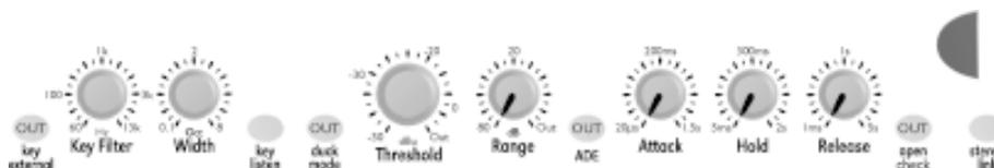
Ajuste o controle KEY FILTER para 1kHz e o controle WIDTH em 8 Oct. Com um sinal aplicado na entrada MAIN e pressionando a chave EXT KEY, você pode agora escutar o programa. Gire o controle WIDTH e note que a faixa de frequências muda e se torna mais limitada quando o controle é girado no sentido anti-horário.
