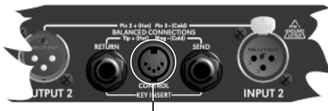
Se a chave KEY EXT estiver acionada, este jack totalmente balanceado é a entrada do sinal para Side Chain do DPR-522. Ele pode ser usado como uma entrada de retorno de um equipamento que está sendo alimentada pelo conector KEY SEND do DPR-522 ou, se requerido, pode ser alimentado por qualquer outro tipo de sinal. *Veja a seção 5.4* para detalhes da fiação desse conector.
