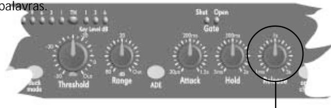
Esta é a fase final da operação e inicia logo após o tempo do HOLD acabar. Ao final do tempo ajustado pelo controle RELEASE, o sinal será reduzido pela quantia indicada pelo controle RANGE. Durante a liberação, o sinal é reduzido logaritmicamente. Isso produz um decaimento sonoro bem natural, essencial para longos tempos de liberação.
