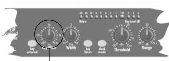
Este controle ajusta a frequência central do filtro do equalizador paramétrico do sinal chave. Este filtro é usado para controlar o conteúdo da frequência do sinal que é enviado ao circuito de controle do gate para permitir que sejam retirados os sinais indesejáveis no controle de acionamento do gate. O filtro não está localizado no caminho principal do sinal e portanto não afeta nada do material que passa pelo gate.
