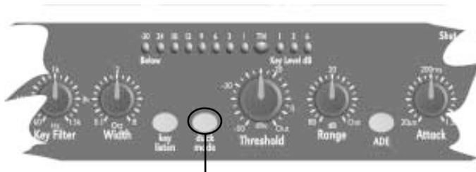
Normalmente, o DPR-522 é configurado como um portão, significando que o sinal está “cortado” até ser acionado e passar pelo portão. O modo mergulho, funciona ao contrário; isto é, quando NÃO existe sinal de acionamento (sinal acima do limiar de acionamento ou uma chave DC de acionamento) o DPR-522 deixa passar o sinal. Quando acionado pelas vias normais, o DPR-522 atenuará o programa para o nível ajustado pelo controle Range.
