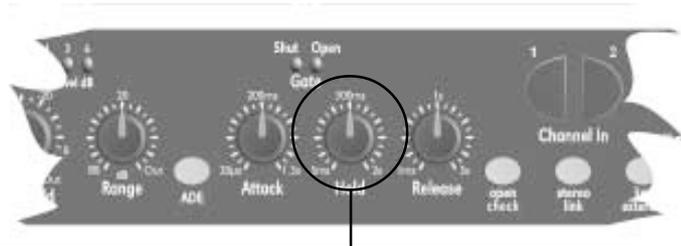
Após completar o tempo de ataque, o DPR-522 mantém o gate totalmente aberto por um período de tempo determinado pelo controle HOLD. O HOLD é necessário para evitar que o DPR-522 inicie uma nova sequência de ataque se o sinal cair momentaneamente abaixo do limiar de disparo.
