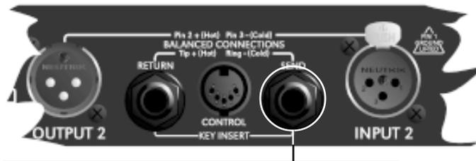
Esta saída “pseudo-balanceada” carrega uma versão amplificada e isolada do sinal da entrada MAIN. Ele pode ser usado assim ou então mandado para a entrada de outros equipamentos para processamento futuro. *Veja a seção 5.1* para detalhes da fiação desse conector.
