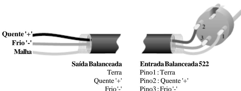
Quando alimentar o DPR-522 com fontes desbalanceadas, ligue o condutor de sinal no pino 2 e a malha do cabo nos pinos 1 e 3. Transformadores isoladores de entrada são disponíveis como uma opção. Contacte o seu revendedor.
