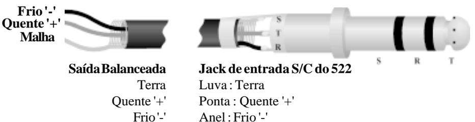
Quando alimentar o DPR-522 com fontes desbalanceadas, ligue o condutor de sinal na ponta do plugue e a malha do cabo no anel e na malha.
