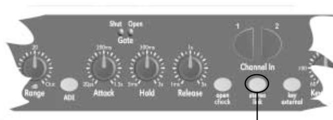
Com essa chave pressionada, ambos os canais do DPR-522 operam simultaneamente.
