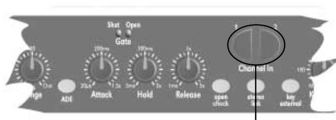
Quando a chave CHANNEL IN está desativada (não iluminada), todas as funções do DPR-522 são desligadas e a entrada está conectada diretamente à saída através de um relé de alta qualidade. Esta é a mesma condição que ocorre quando a alimentação de força está desligada e garante que o sinal passe pela unidade no caso de uma falha da alimentação ou queima de um fusível. Quando a chave é pressionada, o sinal processado estará presente na saída.
