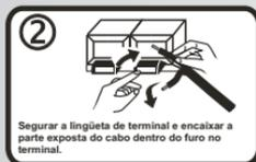
**Importante** : a parte metálica do fio deve estar em contato com a a parte metálica do terminal.
