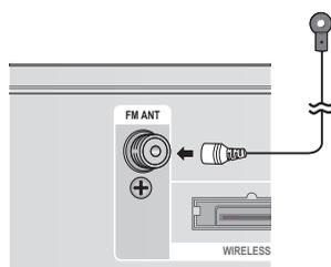
1. Acople a antena FM fornecida ao conector de antena FM.
