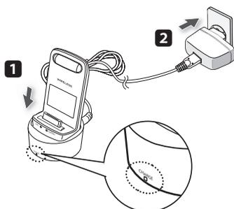
1. Conecte o transmissor sem fio ao suporte de carga.
