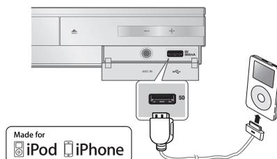
1. Conecte um iPod/iPhone à porta USB frontal usando o cabo USB.
