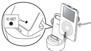
4. Ligue o iPod/iPhone. Pressione o botão "**ID SET**" na parte traseira do transmissor sem fio por 5 segundos. A luz do link no transmissor sem fio piscará rapidamente.
