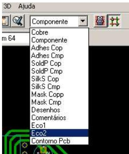
Com todas as ligações terminadas, só falta desenhar o contorno da placa. Para desenhar o contorno, é necessário selecionar a camada própria para isso, no listbox da barra superior seleccione **Contorno Pcb**.
