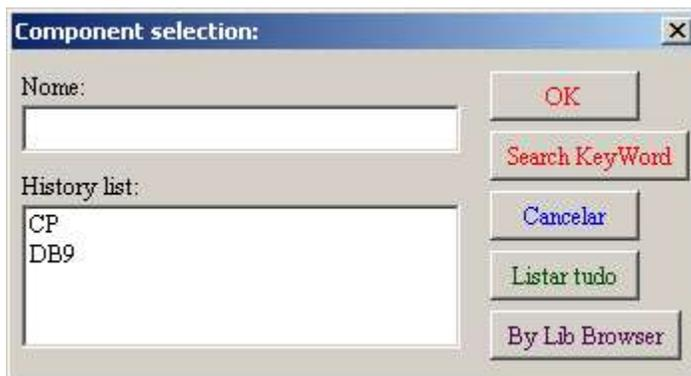
Basta dar um duplo clique no nome do componente CP que aparece na lista (ou selecionar e clicar no OK). Repetir o processo para os demais capacitores (4 no total).
