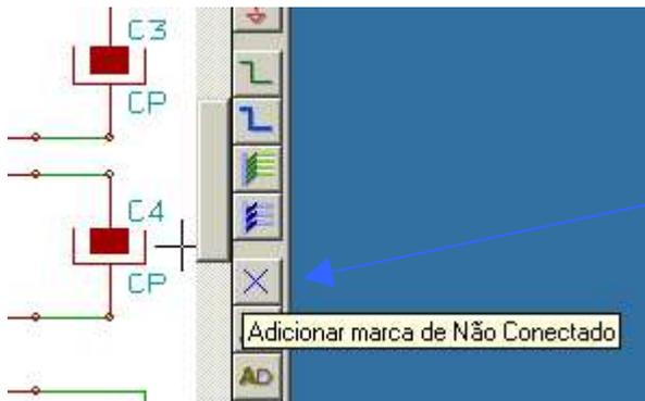
Quando algum pino não for realmente utilizado (ligado), para evitar que a ERC indique um possível problema (um esquecimento), deve-se assinalar o pino com a marca **Não Conectado** (disponível na barra da direita).
