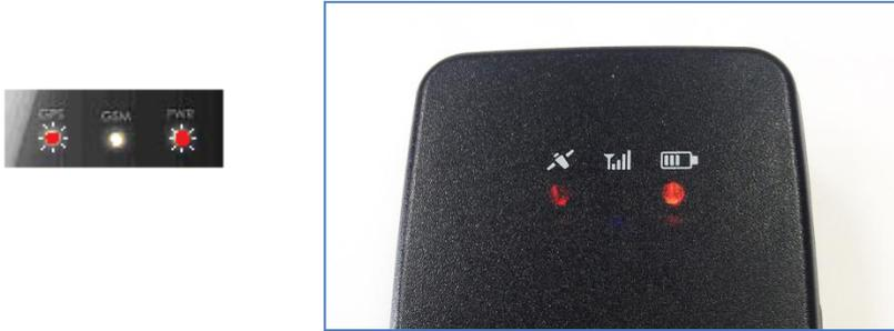
O status do carregamento pode ser acompanhado observando as piscadas do LED da bateria conforme abaixo:
