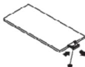
2. Coloque a marca (+) da bateria para cima no retentor de bateria.
