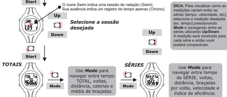
**DICA:** Para visualizar como as medições variam entre as séries (tempo, velocidade, etc), selecione a medição desejada (ex. tempo) pressionando **Mode** e navegando entre as séries utilizando **Up/Down**. A medição será mostrada para cada série e então você poderá compará-las.
