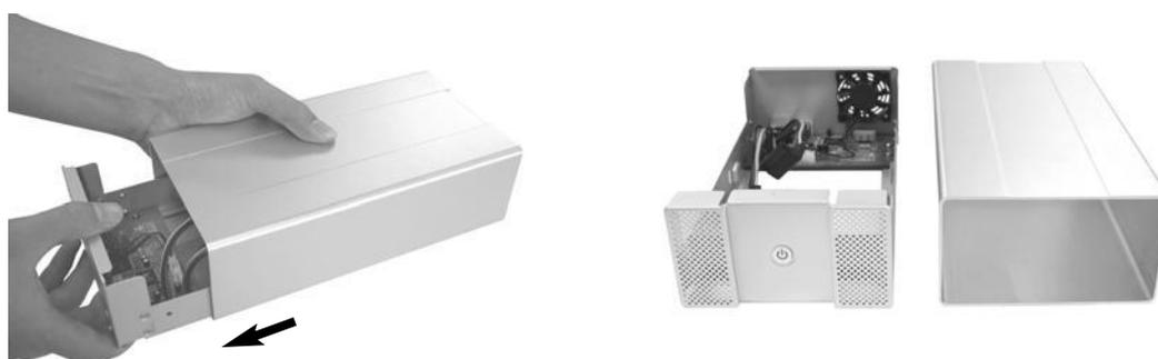
2. Puxe a bandeja pela parte frontal com as mãos na direção indicada na figura acima. Deixe a capa da gaveta ao lado.
