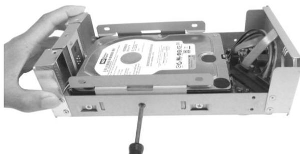
5. Fixe os apoios para o segundo HD inserindo e apertando os dois parafusos como indicado na figura.
