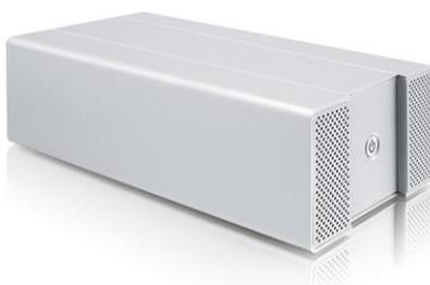
10. Ligue o adaptador AC/DC na gaveta e depois na tomada. Ative a gaveta apertando o botão de ligar no painel frontal. Você pode conectá-lo agora ao seu computador utilizando o cabo de dados USB ou eSATA.
