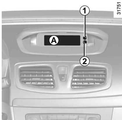
Com a ignição ligada, se pode visualizar a hora e, de acordo com o veículo, a temperatura exterior.
