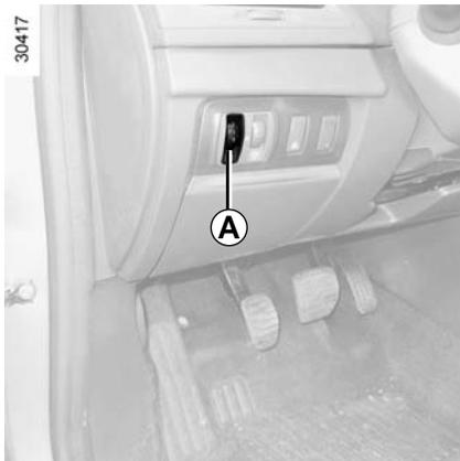
O comando **A**, nos veículos que o tenham, permite corrigir a altura dos faróis em função da carga.
