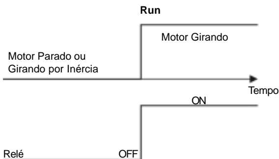
Figura 6.20 - Detalhes do funcionamento das funções das saídas digitais
