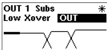
A borda inferior (passa-altas) da banda do crossover pode ser ajustada sobre uma grande faixa de frequências, de OUT (sem queda) ou de 15Hz até 16kHz. Girando a roda de parâmetros no sentido anti-horário reduz a frequência com OUT no último passo. Girando a roda de parâmetros no sentido horário incrementa a frequência até a posição OFF que Muta a saída.
