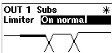
Os limitadores podem ser ajustados como ON NORMAL (ligado normal) ou ON FAST (ligado rápido); o ajuste rápido tem um tempo mais rápido de ataque. Também é possível desligar os limitadores de proteção, girando-se a roda de parâmetros no sentido anti-horário para alterar o display para OFF. Quando os limitadores são desligados, o led OVER ficará iluminado como um alerta.
