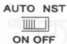
ON – O registro inicia automaticamente, assim que o sinal de frequência cardíaca se torna estável.
