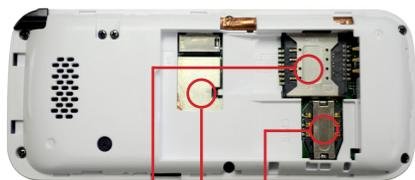
1. Insira os cartões SIM ("chip" das operadoras). Pressione o seu cartão SIM deslizando-o no conector inferior. Para inserir o segundo, basta colocá-lo no conector acima do primeiro cartão.
