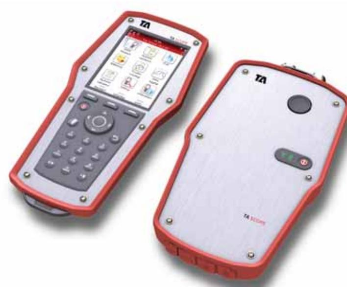
O TA-SCOPE é um instrumento de balanceamento efetivo para medição e documentação precisa de pressão diferencial ( $\Delta p$ ), vazão, temperatura e potência em sistemas hidráulicos.
