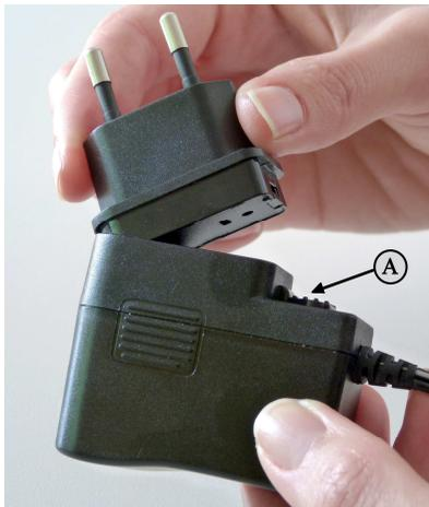
Fig. 1 Adaptadores de plug para a fonte de energia
