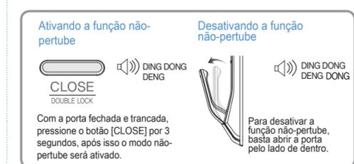
Com a porta fechada e trancada, pressione o botão [CLOSE] por 3 segundos, após isso o modo não-perturbe será ativado. Para desativar a função não-perturbe, basta abrir a porta pelo lado de dentro.
