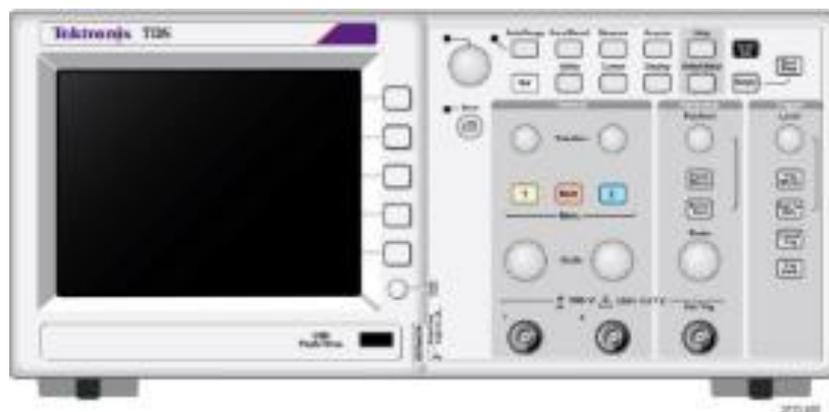
**Figura 4:** Painel frontal do osciloscópio com as chaves e botões que serão relacionadas com as instruções de uso do mesmo para medidas de voltagens variáveis no tempo
