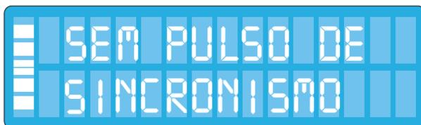
Verifique as conexões e o estado do cabo. Se isso não resolver pode ser necessário ajustar o ganho do amplificador de entrada de ECG no monitor cardíaco. Consulte o manual do usuário ou o fabricante do monitor.
