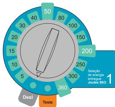
O Apolus identifica automaticamente que está operando com pás internas. A energia no modo de pás internas é limitada em 50 Joules.
