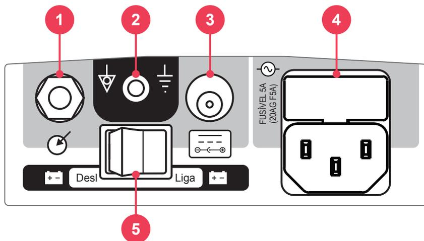
1. **Entrada de sinal de ECG:** conector de entrada de ECG (1V/m V) para desfibrilação sincronizada.
