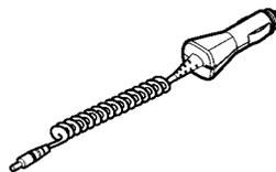
A voltagem de entrada varia entre 11 e 24V, corrente contínua, terra negativo. Evite carregamento prolongado com o Recarregador Rápido para Acendedor de Cigarros (LCH-9) se o motor do carro estiver desligado, pois poderá descarregar a bateria do carro. Note também que, em alguns veículos, o plugue do acendedor de cigarros não possui corrente elétrica com a ignição desligada.
