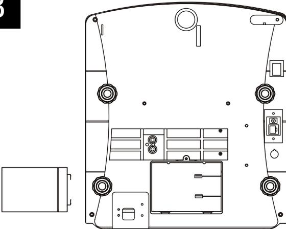
Para instalar a bateria, conecte primeiramente o fio vermelho no terminal vermelho da bateria e em seguida conecte o fio preto no terminal preto da bateria. Após a conexão dos fios, posicione a bateria no compartimento.
