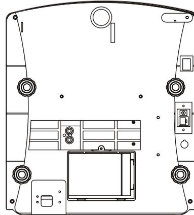
Se for substituir a bateria, retire a bateria antiga desconectando os dois conectores. Se for instalar uma nova, siga para o próximo passo.
