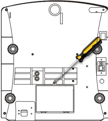
Retire o parafuso philips exibido acima, com auxílio de chave apropriada, para poder acessar o compartimento da bateria.
