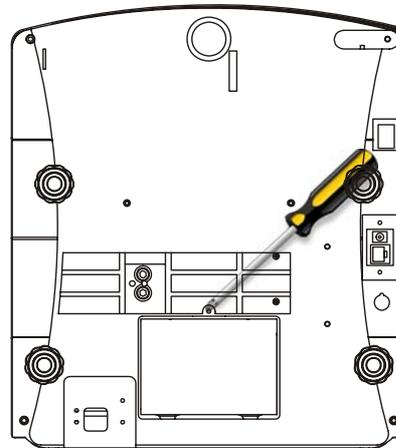
Após o posicionamento da bateria no compartimento, posicione a tampa do compartimento e feche-a utilizando o parafuso philips retirado no passo 1. A bateria está instalada e a balança pronta para o uso.
