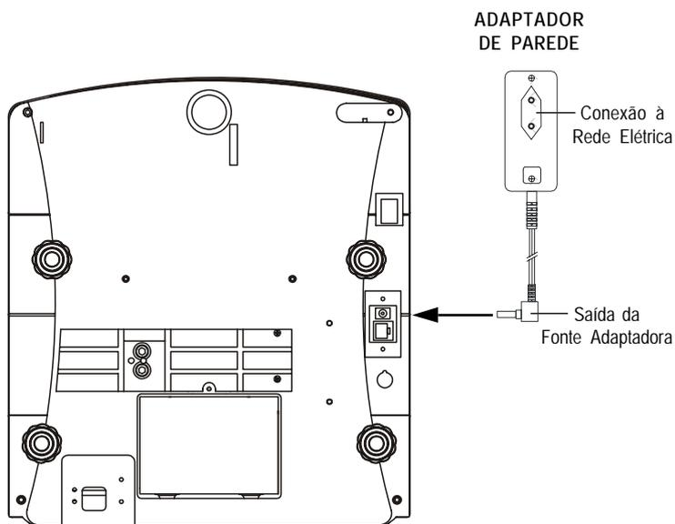
A recarga da bateria será iniciada automaticamente após a conexão do adaptador de parede na tomada e na balança. No início da recarga o display ficará apagado, se a bateria estiver descarregada. O display só acenderá se a balança tiver atingido o nível mínimo de carga. Após a bateria atingir sua carga, o indicador de **Bateria Carregada** se acenderá para indicar que a carga da bateria está completa, permanecendo aceso enquanto o nível de carga estiver no máximo.
