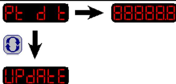
**UPdAtE:** Parâmetro destinado ao ajuste do tempo de leitura dos pulsos de entrada. Para o calculo da velocidade dos pulsos deve ser determinado um tempo para a leitura destes pulsos, de forma que este parâmetro atualiza a indicação desta variável de processo, tornando o equipamento altamente flexível para diversas aplicações. Note que quanto maior a oscilação do processo de leitura, maior deverá ser o valor deste tempo.
