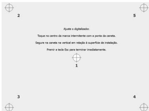
(3) Se o ajuste do sensor for concluído correctamente, é apresentada a mensagem "O ajustamento do digitalizador terminou com êxito.". Em seguida, a calibração é efectuada, por isso aguarde.
