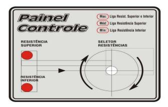
No forno duplo pelo fato de ter duas câmaras se colocam as etiquetas câmara inferior e câmara superior indicando qual painel de controle corresponde à câmara:
