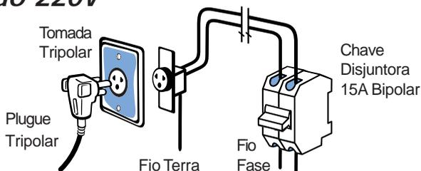
Para o fogão 220V (entre duas fases), utilize um disjuntor bipolar de 15A.
