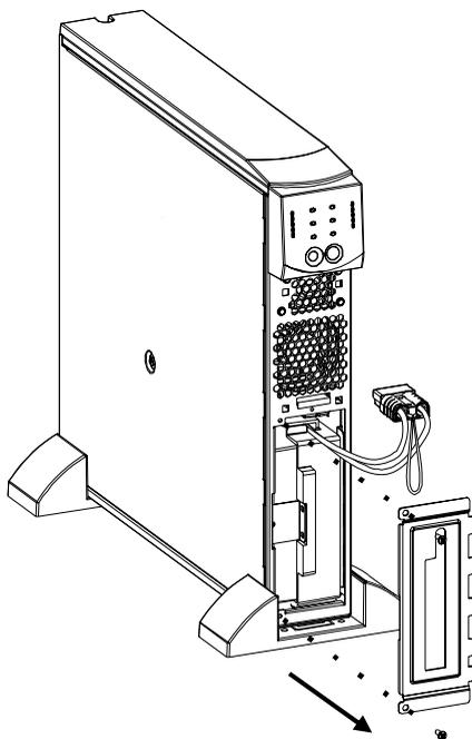
1. Olhando o no-break de frente, localize o compartimento da bateria. O conector da bateria fica pendurado nos cabos que passam por um orifício na tampa da bateria e que vão para dentro do compartimento da bateria.
