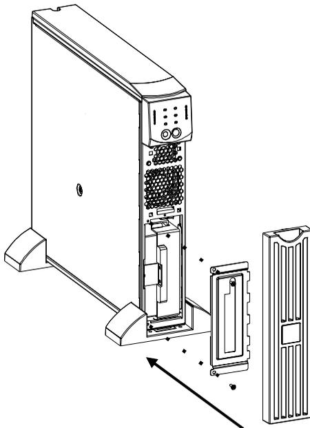
1. Recoloque a tampa da bateria e aperte os dois parafusos nos cantos da tampa. A tampa da bateria deverá cobrir os cabos da bateria e o fio branco.
