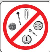
• *Retire os objetos dos bolsos (pregos, palitos, alfinetes, clips, parafusos, moedas, etc.) Eles podem causar sérios danos a Lavadora e às roupas, podendo ocasionar a perda da garantia;*
