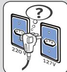
*Antes de ligar a sua Lavadora, verifique se a tensão (voltagem) da tomada onde a Lavadora será ligada é igual a tensão indicada na etiqueta localizada próxima ao plugue (no cabo elétrico).*
