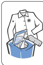
Faça a limpeza da parte interna da Lavadora pelo menos uma vez por mês. Coloque 1 litro de alvejante (água sanitária) dentro do cesto. Selecione o nível de água Alto e programa "TIRA MANCHAS". Deixe a Lavadora completar o ciclo para garantir a total remoção do alvejante.
