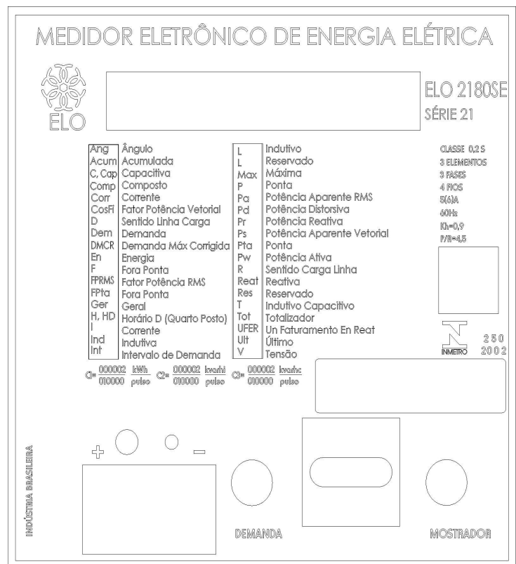
Figura 2.1 - Vista do painel do ELO.2180 configuração de embutir.
