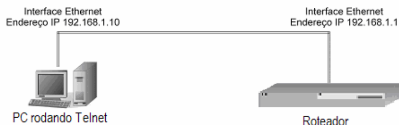
Figura 5-1. Ambiente de Atualização Remota utilizando Telnet/SSH
