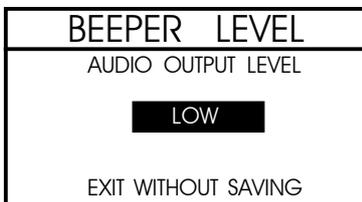
Usando as teclas de navegação, vá ao nível de volume desejado: LOW (baixo), HIGH (alto), ou inexistente (OFF) e pressione a tecla **Enter**. O display retornará ao menu de programação do Analisador (ANALYSER SETUP).
