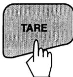
Pressione a tecla **TARE**. Isto faz com que o Analisador de Umidade indique peso zero. Um novo display aparecerá com as instruções.
