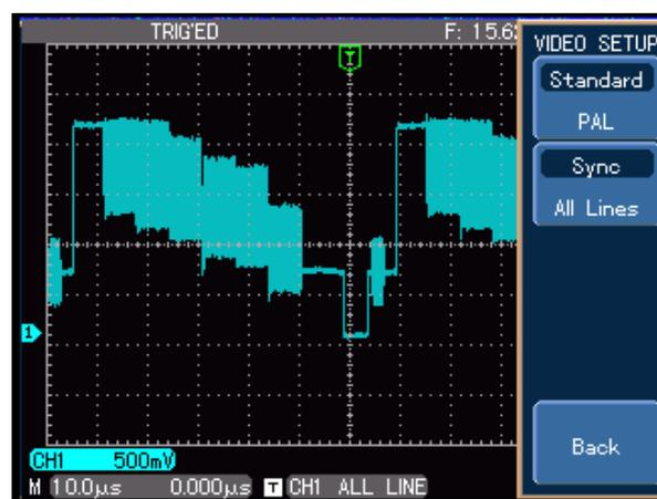
Figura 2.16. Trigger de Vídeo: Sincronização Tipo Linha
