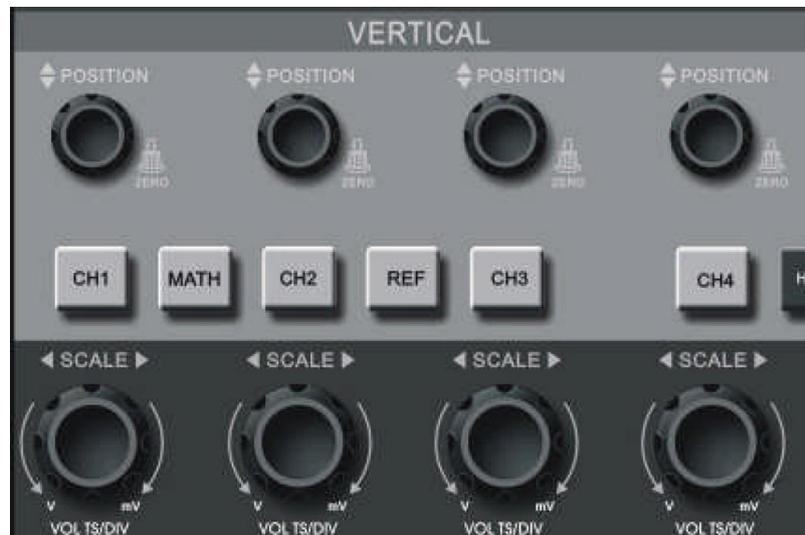
Figura 1.9. Área de Controle Vertical do Painel Frontal
