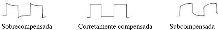
Figura 1.8. Calibração da Compensação da Ponta de Prova
