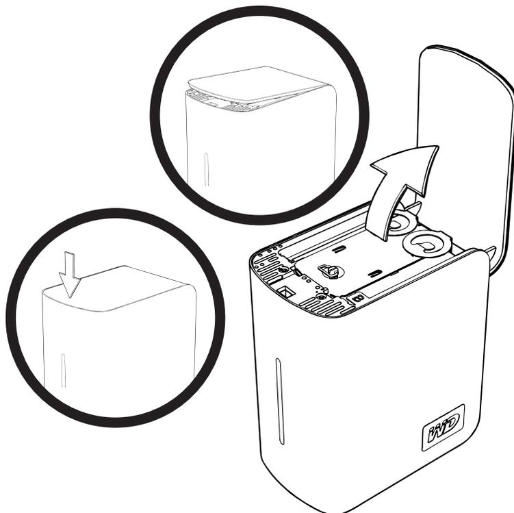
3. Desaperte o parafuso manual que fixa a placa da tampa da unidade. Retire a placa da tampa da unidade e coloque de lado.
