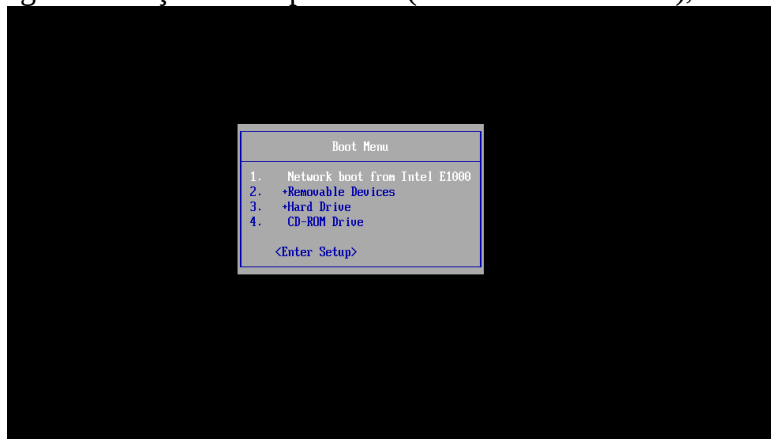
FIGURA 1.20 – SELECIONANDO O BOOT VIA REDE, PELA BIOS (PXE) DO COMPUTADOR.
