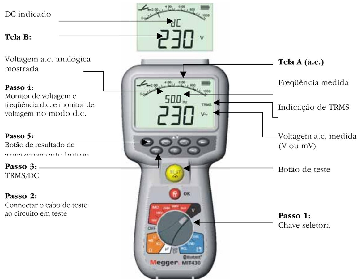
**Figura 5 Medição de voltagem e frequência**
