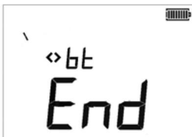
9. O MIT430 / MIT485 deve estar comutado para “OFF” após a combinação, para conclusão do processo.
