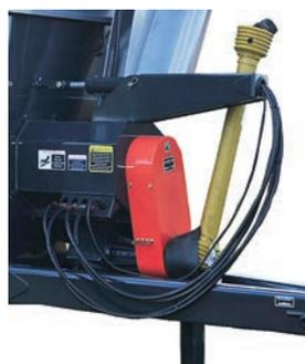
Figura 5.13 - Mangueiras do circuito hidráulico
