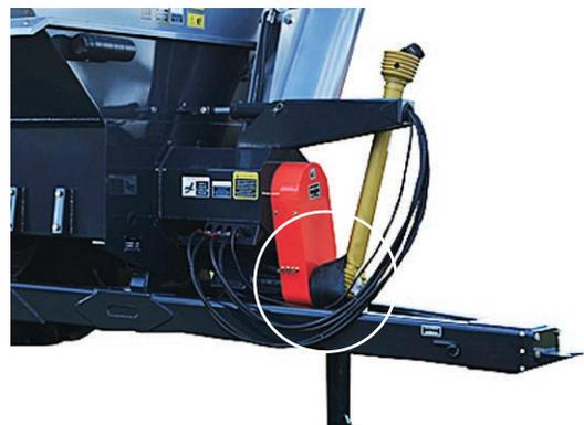
Figura 5.14 - Cobertura de proteção do acoplamento da barra de cardan
